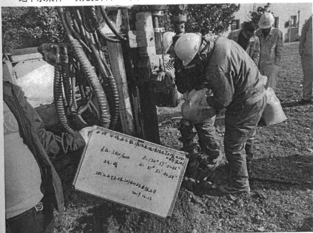
地下水采样—填充滤料和止水材料
