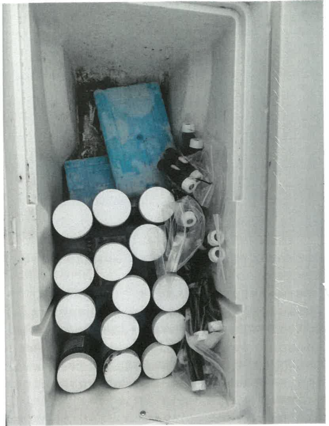
图 5-10 土壤样品置于恒温箱并放置蓝冰盒维持低温
